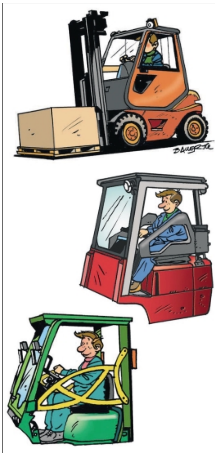
Figure 4. Les différents systèmes de retenue du conducteur actuellement disponibles sur le marché : la cabine fermée et les portillons de sécurité
