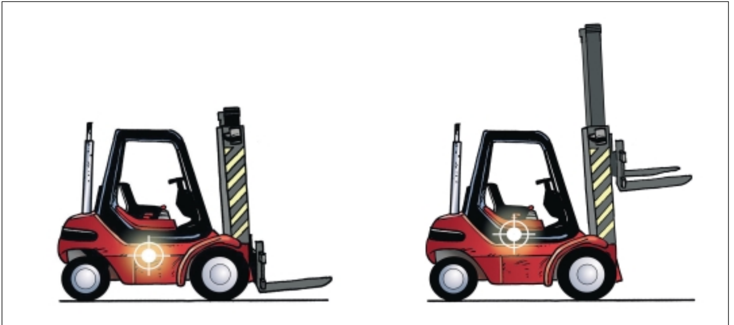
Figure 1. Le décalage du centre de gravité vers le haut entraîne la dégradation de la stabilité de l'engin
